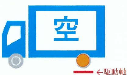
駆動軸に十分な荷重がかからず、発進性能が低下。
