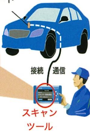
「スキャンツール」をOBDポートに接続し、「OBD」が記録している、各種装置の故障の有無や作動状況を読み出すことで、装置が正常に作動しているかを点検します（いわゆるOBD点検）。
