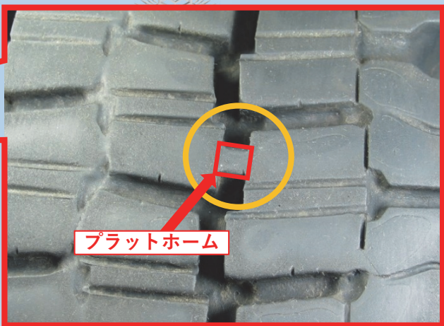
残り溝深さが「プラットホーム」に達している状態。冬用タイヤとして使用できません。
