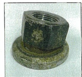
劣化したホイール・ナット
