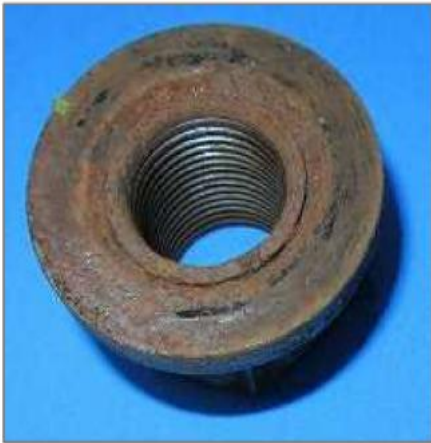
著しいさびや汚れによる ホイール・ナットとワッシャーの固着
